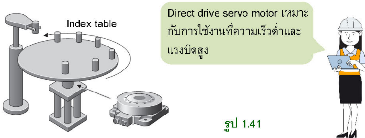
รูปที่ 1.41 เป็นการใช direct drive servo motor หมุน index table หรือ disc table, rotary servo motor สามารถหมุน index table ได้เช่นกัน แต่ DD motor จะรับแรงบิดได้สูงกว่า rotary servo motor
